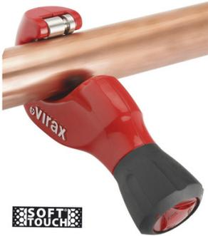
Épaisseur maxi : 2 mm. Coupe précise du Ø 6 jusqu'au Ø 42 mm. 1 molette de rechange. Ebavureur rotatif rétractable à lame interchangeable. Idéal pour les coupes au ras des collets : rouleaux avec gorge.
