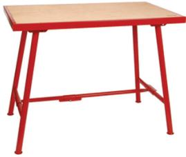
Stabilité : grâce à une large embase. Transport simple : bride pour maintenir les pieds pliés, poids réduit. Fixation pratique d'étau : pas d'épaulement entre le plateau et la cornière. Plateau en bois multiplis avec cadre en cornière métallique. Piètement en tube de Ø 40 mm. Facile à monter et à démonter. Construction très robuste pouvant supporter des poids élevés.
