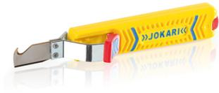
Matière : bi-matière. Lame de coupe traitée au Nitrure de Titane pour une plus grande longévité. Profondeur de coupe réglable. Ajustage automatique de la lame pour coupe longitudinale. Contient une lame de rechange.
