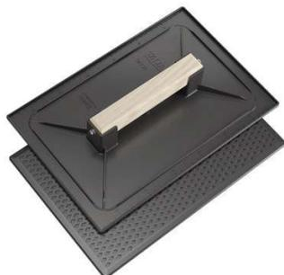
Taloche en PS Choc noir rectangulaire. Qualité standard avec une bonne résistance au choc et à l'abrasion. Possède un plateau alvéolé avec nervure de renfort au verso et poignée bois avec la possibilité de régler le galbe. Destinée aux professionnels et livrée avec clip de brochage.
