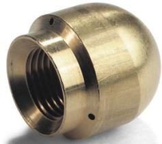
Avec raccord R 1/8" pour montage sur le flexible de nettoyage de canalisations. 3 x 30° vers l'arrière, Ø 16 mm.
