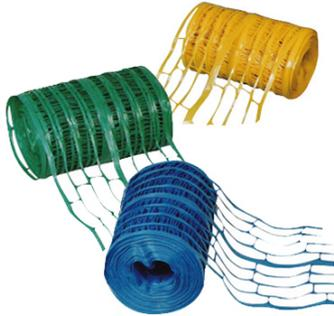
Grillage avertisseur en polyéthylène teinté en masse, conforme à la norme EN 12613 et agréé par le CNET, EDF et GDF. Prédécoupe des brins facilitant la visualisation lors de l'extraction. Emballage unitaire sous film opaque anti U. V. Longueur : 100 m. Largeur : 30 cm. Couleur verte : Télécom.
