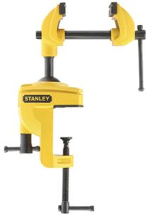
Corps robuste en fonte. Tête sur système de rotule pour une tenue dans toutes les positions. Mâchoire équipée d'un revêtement caoutchouc pour maintien des pièces délicates. Visserie en acier phosphaté pour une meilleure résistance à la corrosion. Base à fixer sur l'établi pour plus de stabilité.
