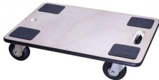
Plateau bois multipli, protégé par 4 plaques antidérapantes et bandeau caoutchouc noir autour du plateau. 4 roulettes pivotantes bandage caoutchouc noir, Ø100, moyeu lisse. 1 poignée de transport. Dimensions plateau: 600 x 400 mm.
