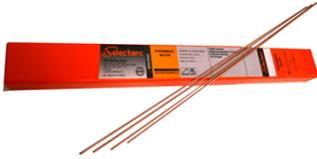
7% de phosphore. Connexion cuivre/cuivre et cuivre/laiton. Bonne coulabilité, alliage universel plomberie. Recommandé pour le brasage des tubes et connexions, chauffe-eau, systèmes réfrigérants. Pour la plomberie et le chauffage.
