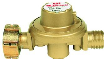
Détendeur fixe 2 bar sortie 3/8e gauche dédié aux fers de couvreur de la marque Express. Pression d'entrée de : 2,5 à 16 bar et pression de sortie : Fixe 2 bar.
