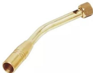
Lances aéro-gaz à flamme dard. Cette lance pour chalumeau assure un brasage fort, spécial tube. Diamètres : intérieur tuyère : 18 mm. Tube cuivre brasure Cu Ph 3 bar : 28 mm. Tube acier brasure 30 % Ag 3 bar : 34 mm.
