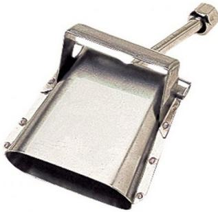
Lances d'étanchéité à brûler et à chauffer à flamme plate. Tuyère à prise d'air arrière, aspiration primaire produisant une excellente flamme dans toutes les positions, notamment dirigée vers le sol. Longueur des flammes : 310 mm.
