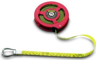
Boîtier semi-fermé en acier recouvert d'une laque époxy très résistante aux chocs et à la corrosion. Grosse boucle de ruban (norme din) avec palette d'accroche totalement escamotable. Ruban acielak, très résistant aux pliures et à l'abrasion. Mécanisme et manivelle en métal chromé. Sortie tangentielle du ruban. Ruban jaune. Graduation en mm pour une parfaite lisibilité en toutes circonstances.
