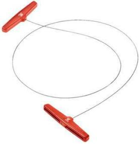
Fil fin dont le trait de scie épais permet une mise en œuvre rapide. Poignées solides. 90 cm. Convient pour le PVC, PVC-C, PP et PE. Mode d'emploi : Disposez le fil autour du tuyau et tirez dessus en un mouvement de va et vient de manière à scier le tuyau. Le fil va s'enrouler.
