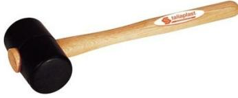
Tête en caoutchouc dur 90 shores. Manche en bois dur traité et vernis pour une excellente résistance à l'humidité. Emmanchement conique. 2 faces plates (diamètre 55) pour tous usages : dallage, carrelage, parquet... Permet de ne pas abîmer le matériau ou l'assemblage lors de la frappe.
