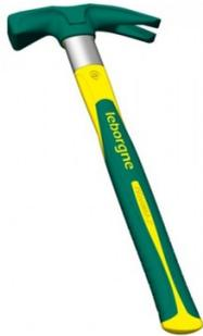
Acier au carbone trempé et revenu. Poignée tri-matière ergonomique anti-glissement, confort de la prise en main. Partie inférieure du manche évasée, anti-échappement. Aimant porte-clou, pointer d'une main sans tenir le clou. Surfaces de frappe latérales, pointer dans les espaces réduits. Arêtes supérieures vives : racler les résidus de béton. Extrémité du manche en polymère dur, ajuster les matériaux sans les abîmer.
