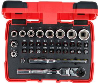
Avec entraînement 6 pans selon DIN 3126 / ISO 1173 - C 6,3. Pour une utilisation manuelle ou avec visseuse. Embouts avec code couleur. Cliquet réversible 72 dents. Tête inclinable à 180°. Finition chromée satinée. Chrome Vanadium. Avec rallonge et adaptateur 1/4". Rallonge pouvant être utilisée comme poignée en T. Coffret bi-matière avec coins renforcés.
