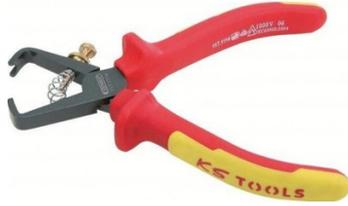
Pour conducteurs unifilaires, multifilaires et fils fins, isolation plastique ou caoutchouc diam. max. 5,0 mm et section 10 mm<sup>2</sup>. Réglage simple du diamètre du câble ou du fil grâce à l'écrou moleté et au contre-écrou. Acier à outils spécial, forgé, trempé à l'huile.
