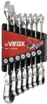
Tête flexible à 180° et fourche avec un angle de 15°. Clé à cliquet avec un angle de reprise de 5°. ?il à profil 12 pans : mise en place facile sur l'écrou. Clé idéale pour les serrages dans les endroits difficiles d'accès. Le jeu contient les dimensions les plus couramment utilisées : 8, 9, 10, 11, 12, 13 et 17 mm. Livrées dans un étui de rangement. Dimensions indiquées sur l'étui, permettant une sélection rapide et un rangement facile.
