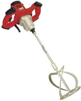
Malaxeur électrique portable adapté aux matériaux tels que : plâtre, ciment, mortier, colle à carreaux et crépis avec 2 vitesses variables pour un malaxage parfait. Variateur de vitesse. Poignées ergonomiques avec butées de renfort. Vitesse 1 : 0-570 tr/min et vitesse 2 : 0-760 tr/min. Livré avec : 1 fouet ø 140 mm, 3 rubans. Clefs de maintenance.
