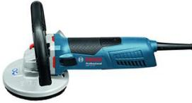
Puissante ponceuse à béton avec carter endurant en métal. Moteur très puissant de 1 500 W assurant une progression de travail rapide quelle que soit la charge. Poignée ergonomique et grande légèreté pour un grand confort d'utilisation. Système d'étanchéité aux poussières optimisé et carter anti-poussière en métal. Livré en coffret standard avec : 3 couronnes porte-brosse 2 608 620 691. Clé à ergots coudée 3 607 950 017.
