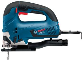
Scie sauteuse fiable à poignée étrier pour performances d'entrée de gamme. Poignée étrier avec gâchette de vitesse pour des coupes de qualité constante jour après jour. Changement de lame facile et sans clé grâce au système SDS Bosch. Progression de travail rapide grâce au moteur fiable de 650 W. Coupe aluminium : 20 mm / Coupe bois : 90 mm / Coupe métaux : 10 mm. Livré en coffret standard. Longueur du câble : 2,5 m. Filaire
