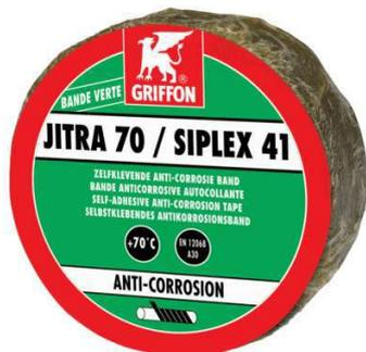
Bande anticorrosion à base de petrolatum pour la protection des conduites, des raccords et d'autres structures métalliques souterraines et aériennes. Utilisable lorsque la température d'exploitation se situe entre -30 °C et 70 °C.
