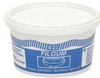
Mastic pour l'étanchéité des joints de bonde, des emboîtements de tuyaux en évacuation, des plans de joint ou la réalisation de bourrages. Bonne adhérence sur céramique, métal, matières plastiques, bois, verre... Résistance jusqu'à +100°C. De couleur beige, peut aussi se peindre. La texture reste souple dans le temps, ne durcit pas.
