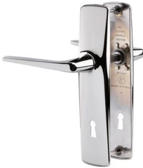
Solidité à toute épreuve, conçu pour un usage intensif. Pour montage sur petite plaque. Finition chrome miroir. Ensemble monobloc : béquille et plaque solidarisées. Plaque fondue avec piliers taraudés intégrés et vis invisibles côté extérieur.
