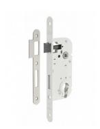
Coffre acier embouti. Têtière acier. Demi-tour alliage réversible sans démontage du coffre. Pêne alliage. Gâche plate acier. Mécanisme à 1 tour. Carré 7 mm, entraxe 70 mm. Sans rappel du 1/2 tour par la clé.
