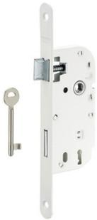
Coffre acier embouté. Têtière acier. Demi-tour alliage réversible sans démontage du coffre. Pêne acier. Gâche plate acier. Mécanisme à 1 tour. Carré 7 mm, entraxe 70 mm.
