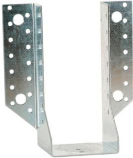
Il peut être utilisé sur des solives, des pannes, des lisses et des montants de bardage ainsi que sur des butées de chevrons ou en renforcement d'assemblages existants et il peut être posé sur des supports porteurs et portés en bois massif, composite ou lamellé-collé et, uniquement pour les supports porteurs, sur de l'acier ou du béton.
