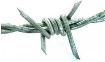
Fil barbelé à torsions alternées. Réalisé avec 2 fils en torsades et ronces à 4 picots, pour clôturer les terrains agraires et le bétail. Ronce dure. Fils à torsions alternées. Revêtement en Zincalu offrant une longévité 3x supérieure à une galvanisation normale.
