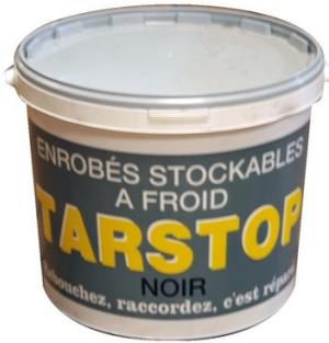
Enrobé stockable pour interventions ponctuelles sur chaussées. Dépoussiérer les trous et autres surfaces, remplir au dessus du niveau puis damer. Pour les parkings, poser une planche et rouler dessus. Laisser sécher 48 heures.
