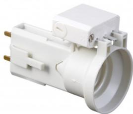
Douille de type DCL sans interrupteur. Tension assigné 250V-. Courant nominal 4A. Accepte toutes les ampoules de type E27.
