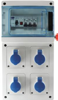
Coffret de chantier de marque Eur'ohm. Fabriqué selon les normes en vigueur. Il est équipé de : 4 prises 2P+T 16 A, 1 arrêt d'urgence, 1 voyant lumineux. 2 disjoncteurs Ph/N 16 A, 1 disjoncteur Ph/N 2 A, 1 interrupteur différentiel 30 mA et 1 arrêt d'urgence.
