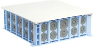
Boîte pavillonnaire à grande capacité de connexion pour bâtiment HQE, à 40 entrées directes multi-diamètres. Dimensions(mm) extérieures avec couvercle 250 x 250 x 87, intérieures 210 x 210 x 85. Accepte gaine ICTA D16, D20, D25 et D32.
