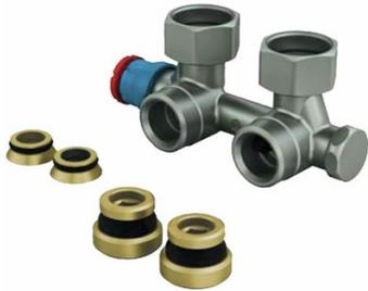
Robinet thermostatisable équerre pour panneaux plats. Livré avec capuchon de chantier. Livré avec adaptateurs pour passage en 3/4" Eurocone (R483Y001) et 1/2" gaz (R483Y002). Départ côté tête thermostatique. Ajouter le R178E pour le tube cuivre ou le R179E pour tube PER/PB et Multicouche.
