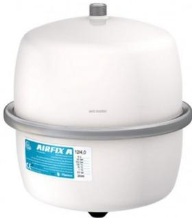
À circulation partielle. Couleur: RAL 9010. Pressions de service maximales : 10 bar (Airfix A 35 - 80 : 8 bar). Vases conformes EN13831. Température minimale / maximale admissible en continu par la membrane : 1 / 70 °C. Conformes à la directive PED 2014/68/EU.
