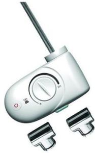
1 résistance électrique avec thermostat analogique blanc, classe 2, niveau de protection IP44, disponible de 300 à 1200 watts, 230V. Livrée avec câbles d'alimentations blancs et fil pilote, 2 raccords à gaz chromés en T de 1/2", 1 bouchons en laiton nickelé de 1/2" gaz M avec O-Ring, instructions de montage.
