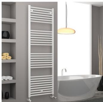
Collecteurs verticaux en acier au carbone vernis semiovale 30x40 mm. Corps radiants horizontaux en acier au carbone vernis ø 22 mm. Fixation : Consoles, clé hexagonale, vis et chevrons pour parois en dur, instructions de montage. Le kit est conforme à la norme VDI 6036 - classe 4. Traitement de surface : peinture époxy-polyester écologique selon DIN 55900-1.2. Teinte : Couleur standard en Ral 9010.
