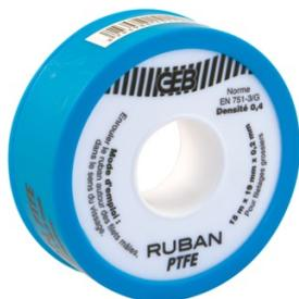
Pour l'étanchéité des raccords filetés métalliques : étanchéité des circuits d'eau potable, étanchéité des circuits d'eau chaude et froide en sanitaire (ECFS) et en chauffage. Il convient également pour l'étanchéité des circuits d'hydrocarbures et de produits chimiques. Le PTFE est stable de -260°C à +260°C et résiste aux pressions jusqu'à 15 bars.
