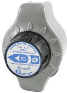
Se pose après la première détente. 3 fonctions : Robinet d'arrêt, détente et sécurité (coupure du débit en cas de chute de pression amont et excès de débit). Conforme aux normes NF M 88 773. Débit 1.3 kg/h. Pression amont 0.1 à 0.6 bar. Pression aval 28 mbar.
