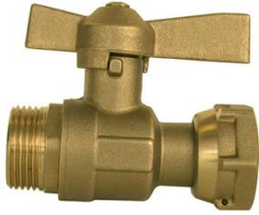
Ecrou tournant avec 1 trou de plombage. Matière laiton CW617N. Joint torique en NBR (80°C max). Siège en PTFE. Poignée papillon asymétrique (laiton). PN25.
