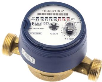
Compteur divisionnaire MID, modèle eau froide, certifié ACS 4MS, corps en laiton, lecture directe sur 8 rouleaux, indice de protection IP68 pour réseaux de distribution d'eau.
