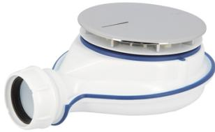
Bonde avec clapet et contre-clapet Magnetech + garde d'eau 1 cm, système anti-remontées d'odeurs. Haut Débit 33l/mn. Etanchéité instantanée garantie grâce aux joints co-injecté au corps de la bonde. Hygiène et facilité d'entretien grâce au siphon extractible. Sortie horizontale à visser ou à coller.
