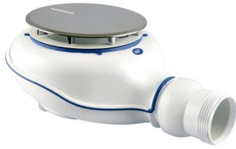
Très haut débit 43L/min. Rotule orientable à visser ou à coller. Encombrement : 80 mm et garde d'eau : 50 mm. Raccordement à la canalisation : à visser G1"1/2. Corps bi-matière : polypropylène + élastomère et capot métal en zamac chromé ou PVC selon modèle.
