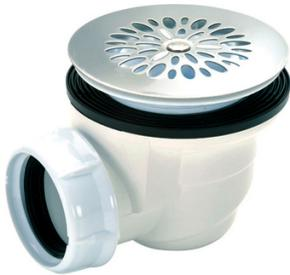
Bonde à grille inox. À siphon amovible démontable. Sortie à visser ou à coller. Garde d'eau 50.
