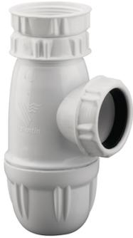
Siphon pour évier. Hauteur réglable de 62 à 97 mm. Encombrement réglable de 149 à 184 mm. Sortie diamètre 40 mm et entrée 1"1/2. Débit 54 l/mn. Certifié NF.
