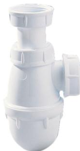
Siphon universel pour tout type de lavabo. Entrée en 1"1/4 réglable en hauteur. Sortie pour tube Ø 32. Garde d'eau 50 mm. Débit 43 l/mn (sous 120 mm d'eau)
