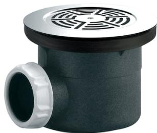
Bonde receveur de douche Ø90 mm. Grille inox Ø 115 mm, serrage max.25 mm. Corps plastique. Sortie horizontale à visser/coller. Débit 30 l/mn. Technologie Fit express : joint Autofix. Technologie Cleany Quick : nettoyable sans outils et sans produits chimiques. NF
