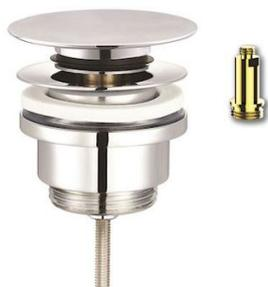
Bonde pour vasque avec ou sans trop plein, universelle. Clapet laiton chromé de diamètre 68 mm digiclic ou fixe. Vis centrale M6 x 80 mm. Serrage de 10 à 80 mm. Corps en laiton chromé. Débit fluide de 33 l/mn.
