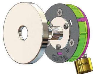
Montage express, moins de cinq minutes. Montage sécurisé, par fenêtres de contrôle. Facile à carreler, pas de sur-épaisseur due aux chevilles. Démontable, la connexion avec le tube reste visitable après carrelage. Convient à toute les épaisseurs de cloison, au-delà de 13 mm. Kit pré-assemblé, prêt à monter.
