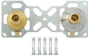
La platine se fixe avec les 5 chevilles qui sont à retirer laissant ainsi la surface plane pour la pose du carrelage. Les 2 coudes se clipsent sur la platine. Les rosaces de votre robinetterie se visse.
